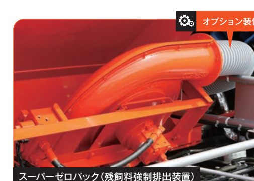
スーパーゼロバック(残飼料強制排出装置)
