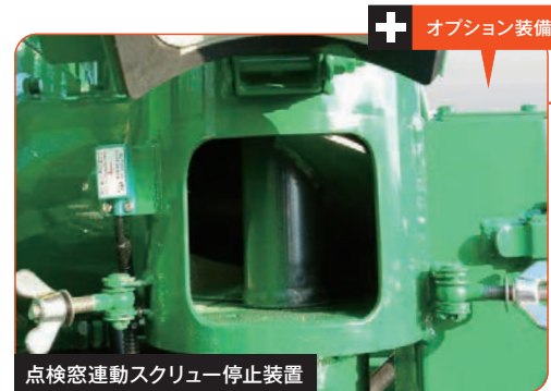
点検窓運動スクリュー停止装置
